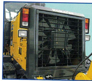
Inversão de sentido do ventilador de arrefecimento
